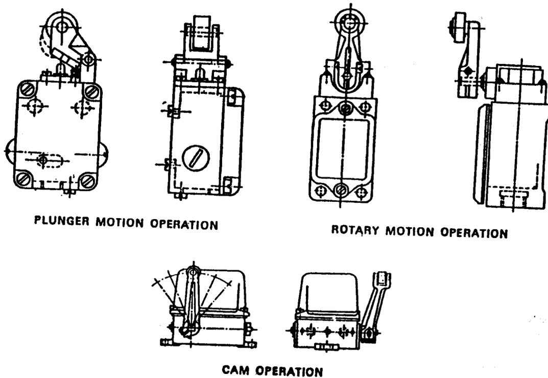
FIG.2 TYPICAL LEVER TYPE LIMIT SWITCHES (WITH ROLLER)
